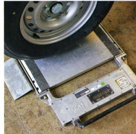
Kontrolle ist besser: Bevor es auf den Prüfstand geht, werden Achs- und Stützlast exakt auf die vorgegebenen Werte eingestellt.
