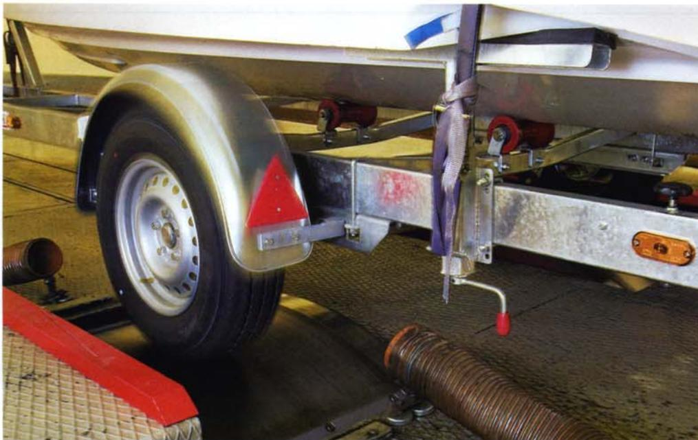
**So tun als ob: Jeder Trailer muss auf dem Rollenprüfstand 50 km zurücklegen. So werden im Zeitraffer-Verfahren 5000 durchschnittliche Straßenkilometer simuliert.**
